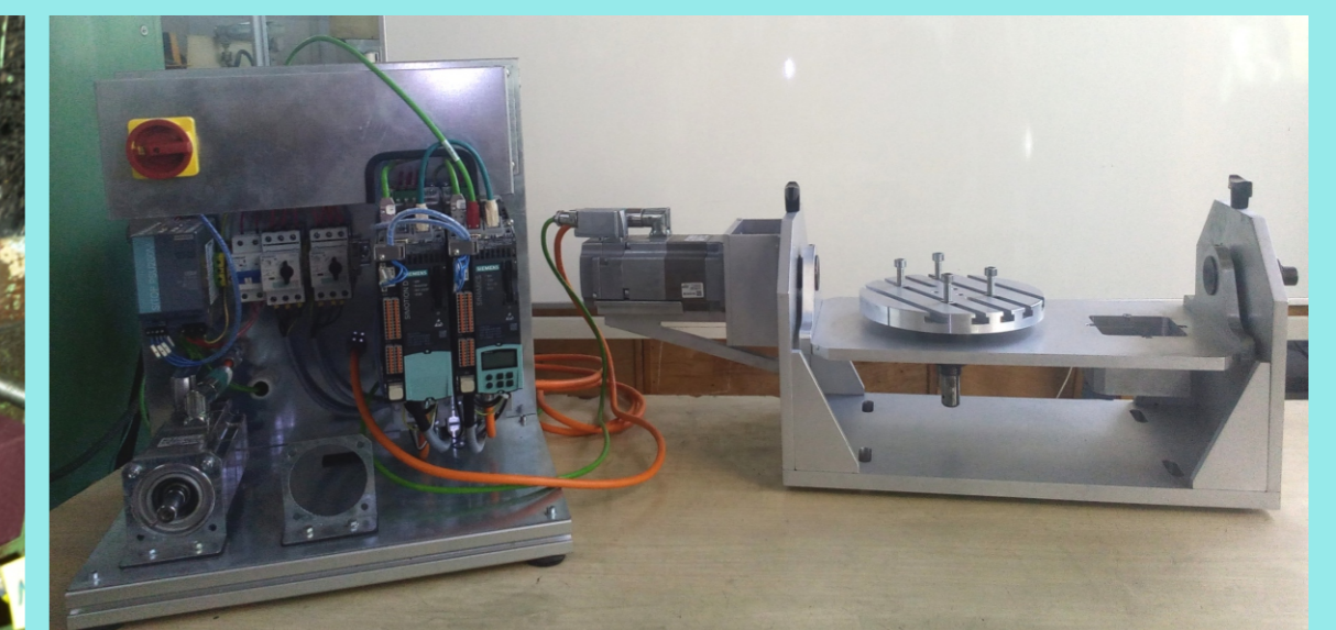
Stand experimental pentru comanda si actionarea simultana a doua axe
